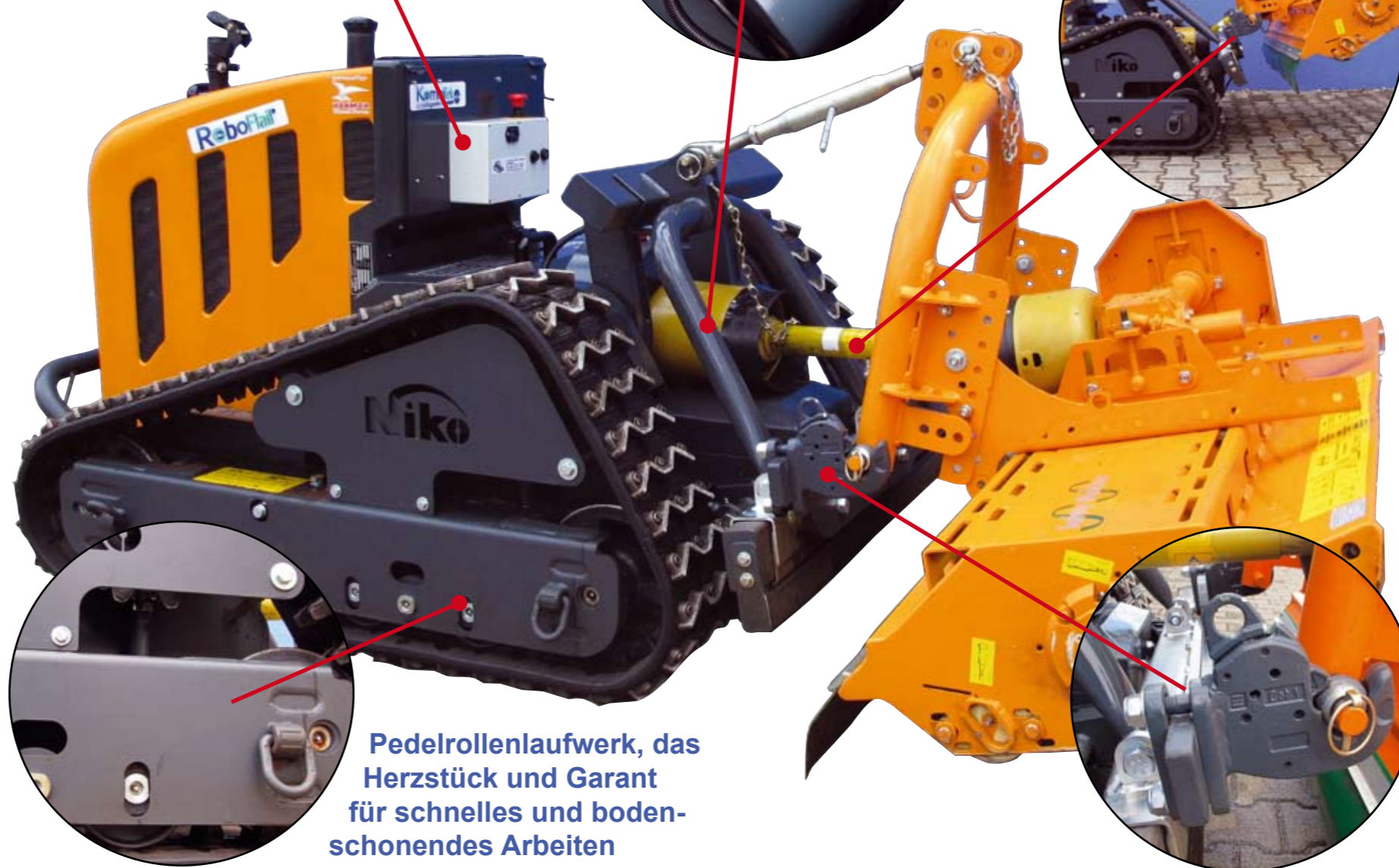
Geräteausnahme Kategorie 1 - ein Standardsystem zum Anbau ihrer vorhandenen Anbaugeräte
