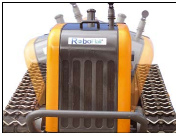
Automatisches Schwenken des Yanmar Diesel Motor mit Cleanfix Wendelüfter
